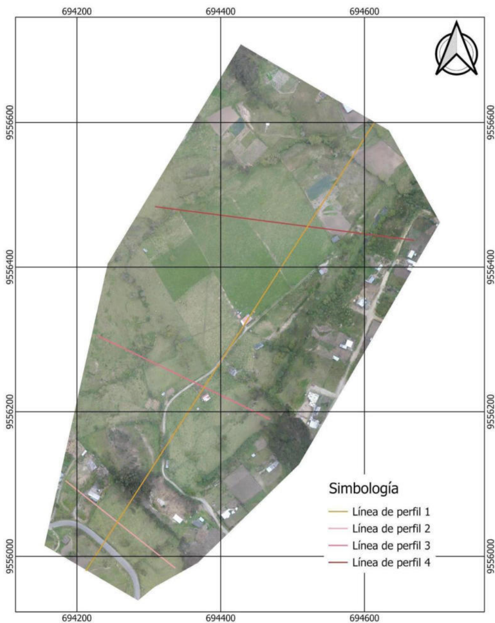
Figura 24. Ubicación de las cuatro líneas de perfil en la zona de estudio para analizar el comportamiento de los desplazamientos verticales en cuatro secciones.
