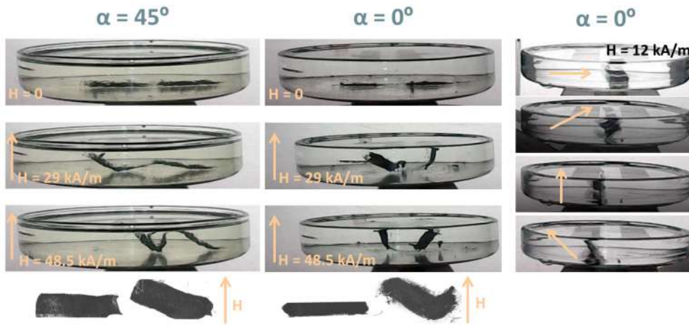
Figura 5.5: Fotografías del actuador con forma de gusano y partes magnéticas alineadas a 0^\circ y 45^\circ bajo campos magnéticos aplicados de distinta intensidad o dirección. Se incluyen las correspondientes imágenes de microCT para cada condición estudiada.
