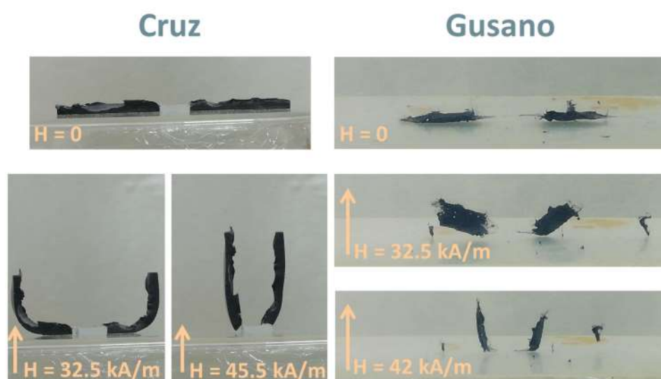
Figura 5.2: Fotografías de los actuadores basados en hidrogeles isotrópicos de alginato con forma de cruz y de gusano bajo campos magnéticos aplicados de distinta intensidad.
