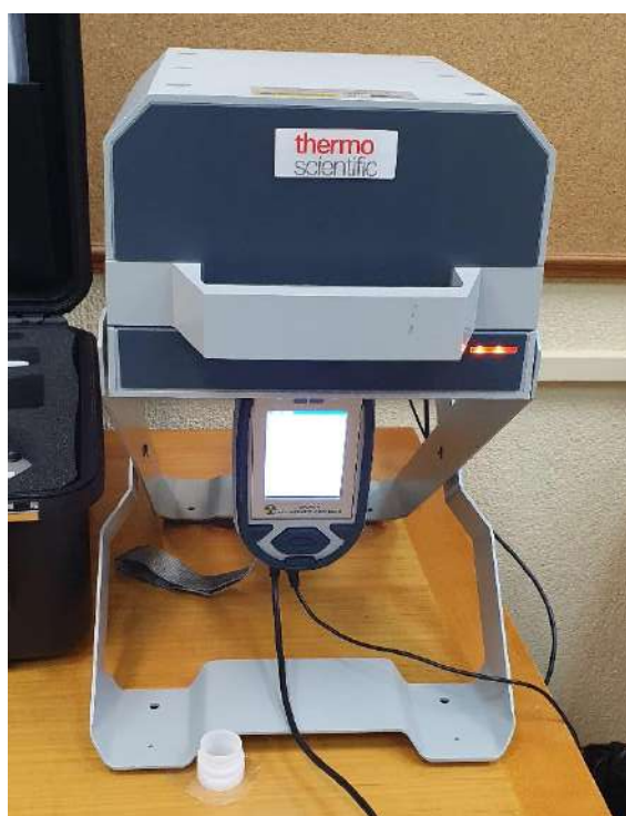
Figura 14 Espectrómetro portátil de rayos X, con cúpula de seguridad Niton XL3T950 GOLD+. Fotografía realizada por el autor.
