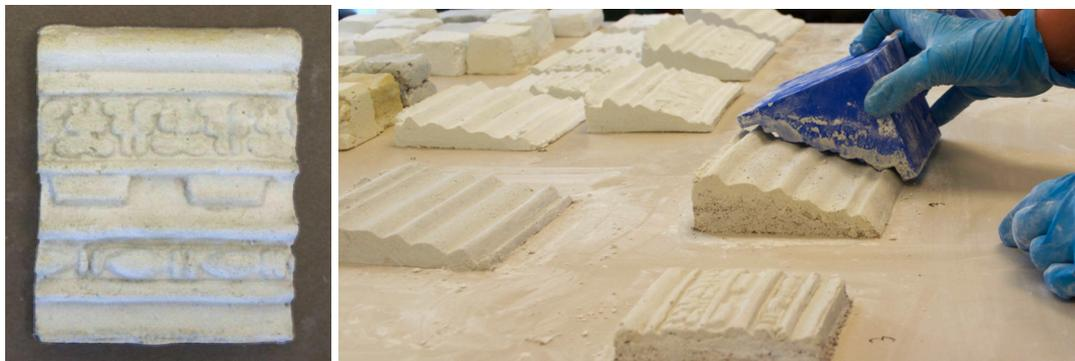
Figura 7. Izquierda: Elaboración de prototipos o reproducciones de cornisas. Derecha: Aplicación de técnicas tradicionales de elaboración para su realización: moldes y terrajas realizados mediante impresión 3D.
