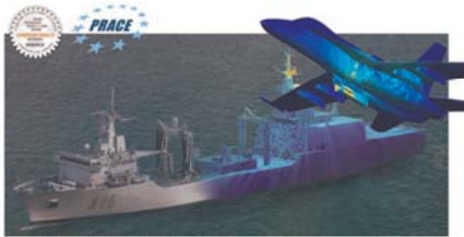
Corrientes inducidas por la radiación de una antena embarcada, sobre la superficie de un barco y la de un avión (LVGO-UEX). Premio europeo PRACE de computación.
