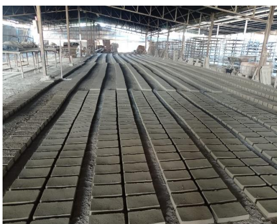
Il. 16. Detalle de los ladrillos hechos manualmente. Imagen de autoría propia.
