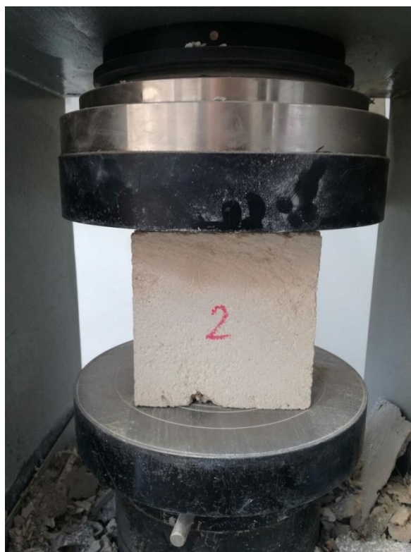
Figura 4. Ensayos de compresión realizados al tufo materano.
