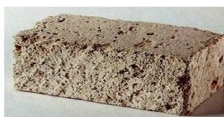
Fig. 34: Tabla sobre las propiedades físicas y mecánicas de tres bloques de calcarenita de una cantera de Montescaglioso. Imagen 2: foto de Bloque de calcarenita (Tufo) Fuente: AAVV.:Laboratorio di pratiche della conoscenza nei Sassi di Matera. Pág.60-61
