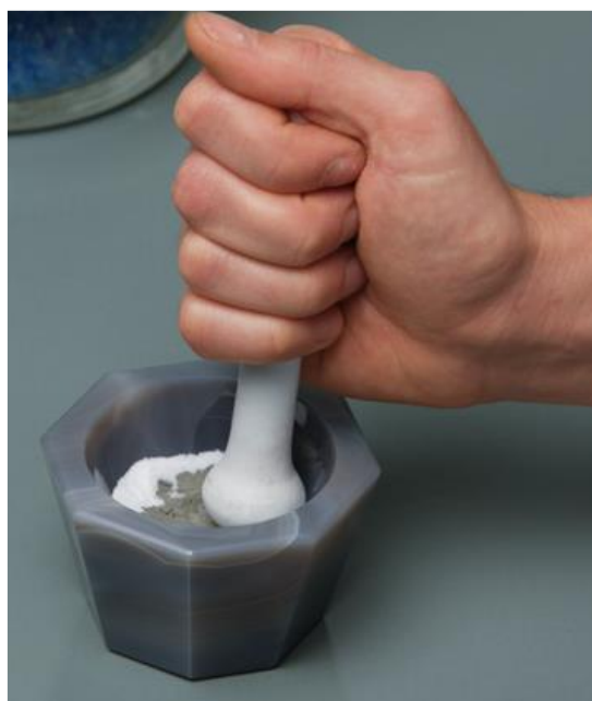
Figura 2.16 Preparación de la pastilla de mineral en polvo para la técnica XRF
