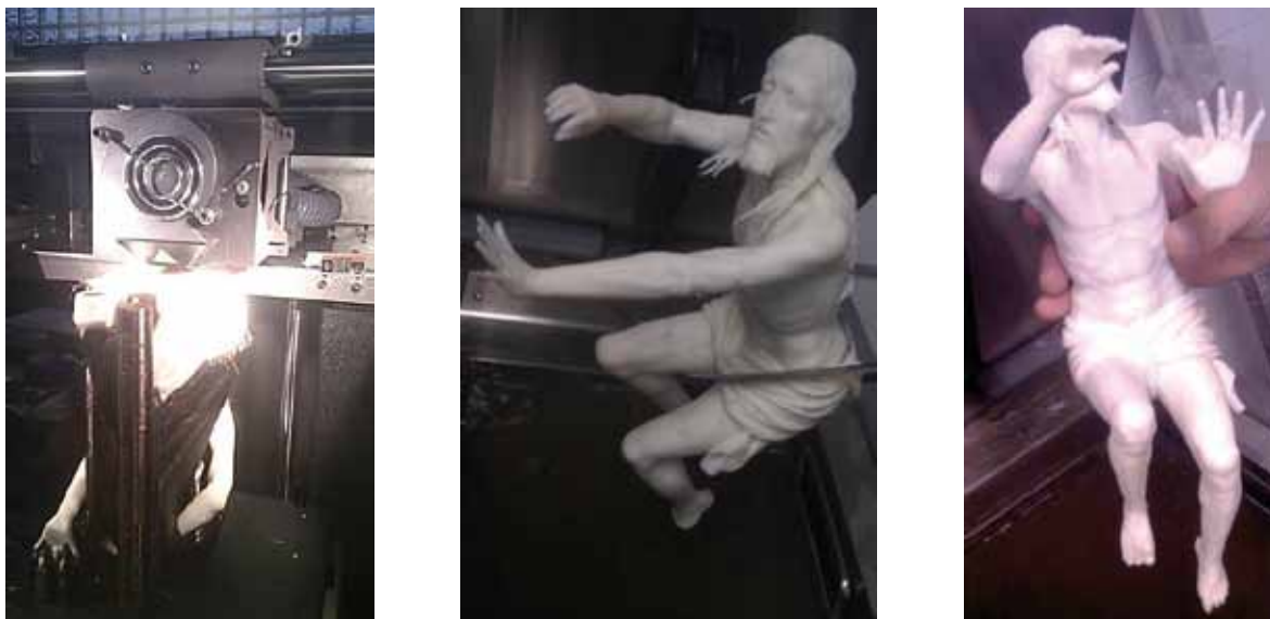
Figura 7. Proceso de impresión escala 1/5 en resina ABS del Backup3D del Stmo. Cristo del Mayor Dolor
