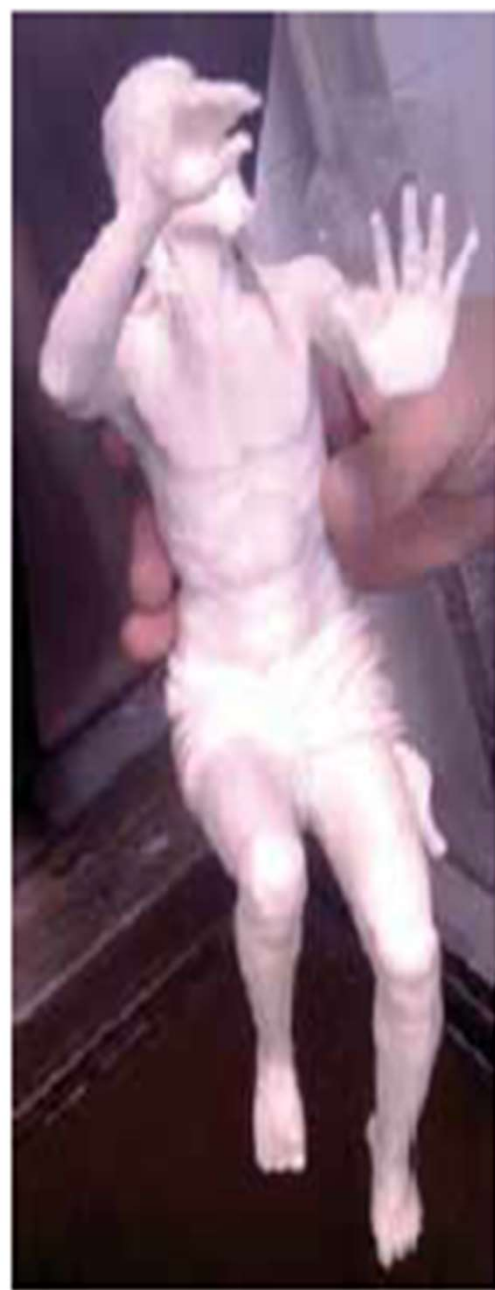
Figura 7. Proceso de impresión escala 1/5 en resina ABS del Backup3D del Stmo. Cristo del Mayor Dolor
