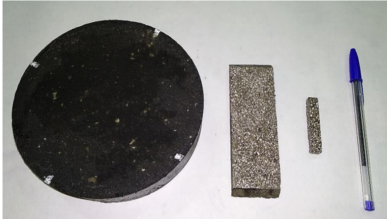
Figura A1 5. Probeta de mortero tras la fabricación en compactador giratorio y corte en la sierra.
