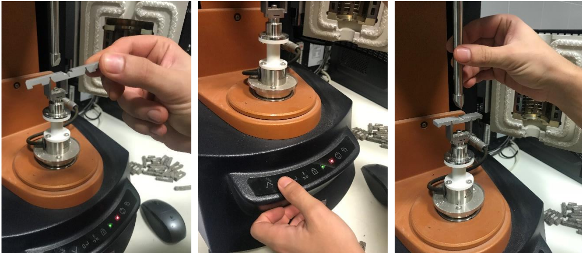
Figura A2 4 Procedimiento de calibración, ajuste de geometría.
