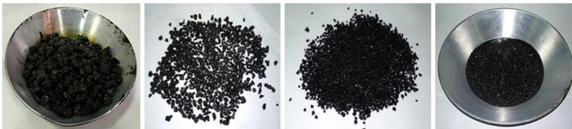
Figura A1 2. Separación de la mezcla de referencia en grupos para la determinación del contenido de ligante. De izquierda a derecha: Grupo 1, 2, 3 y 4.
