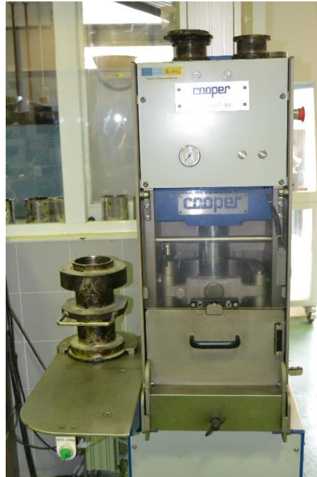
Figura A1 4. Compactador giratorio empleado en la compactación de los morteros.
