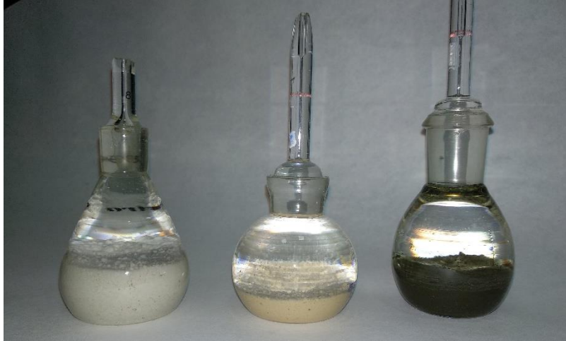
Figura A1 3 Determinación de la densidad real de los distintos tipos de filler
