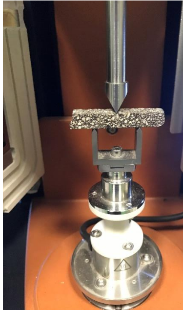
Figura A2 2 Configuración para el montaje del DSR para el ensayo a fatiga en 3 puntos
