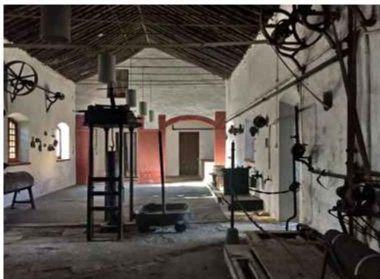
Fig.- II.83. Sistema de transmisión de correas de los mecanismos de la fábrica de aceite.
