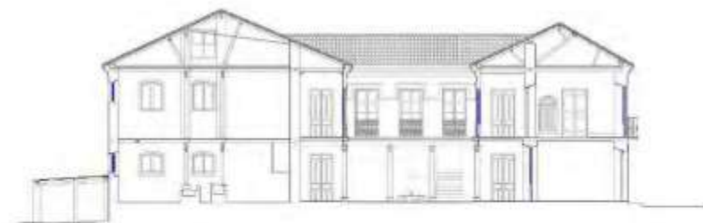
Fig.- II.13. Sección por la crujía de fachada. Se observa la hilera primitiva y la nueva hilera recrecida en altura.
