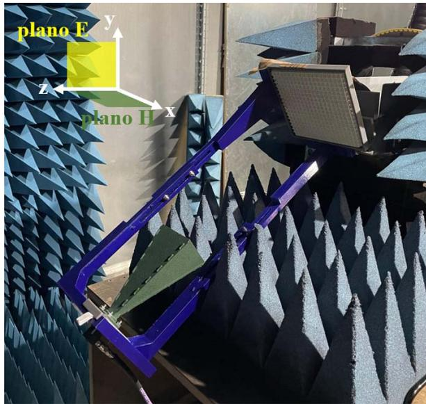
Imagen 3.37: Montaje para la medida del *reflectarray* de doble banda.
