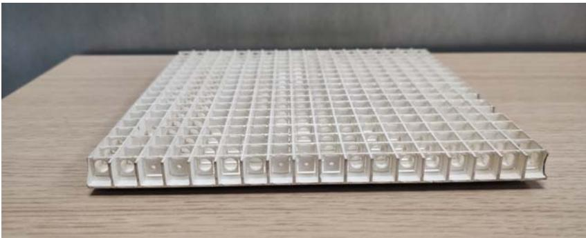
Imagen 3.51: Prototipo ya metalizado del *reflectarray* de doble banda con los resonadores con forma de *C* y *O*.
