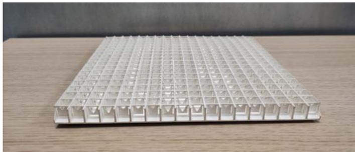
Imagen 3.36: Prototipo del *reflectarray* de doble banda con los resonadores con forma de  $C$  y  $\Delta$ .
