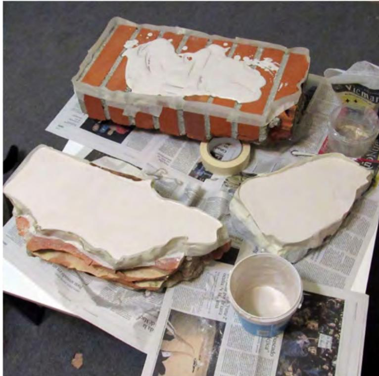
Ilustración 225 - Andreia Falqueto (2019) *Proceso de trabajo*. Después, hicimos limpieza das piezas con agua y jabón, aplicación de capa de yeso. Acervo propio
