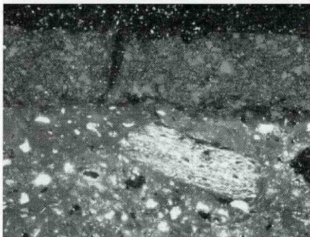
Fig. 21. Lámina delgada de azulejos de producción andaluza. Nícoles cruzados, área real de encuadre: 1,3 x 1 mm. La cubierta es rica en opacificante. En la pasta se observa un gran fragmento de esquisto filítico
