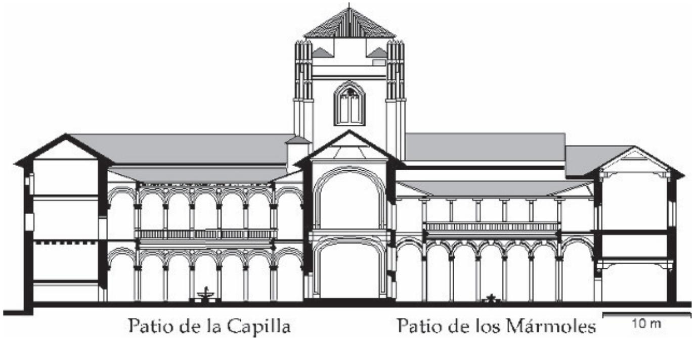
Figura 48: Sección del Edificio del Hospital Real.
