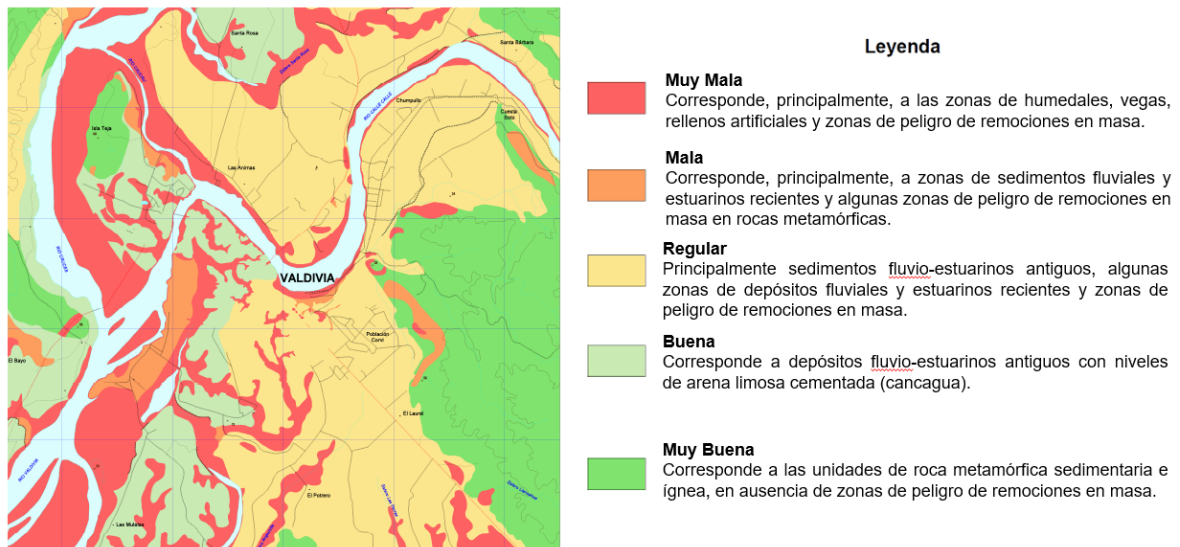
Figura 5-19: Extracto microzonificación sísmica. Fuente: (Alvarado, 2018).
