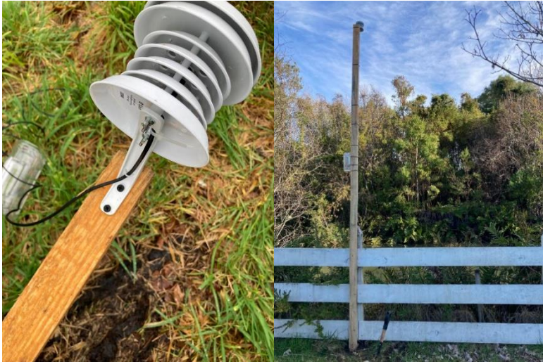
Figura 7-3: Instalación sensor HOBO en U4
