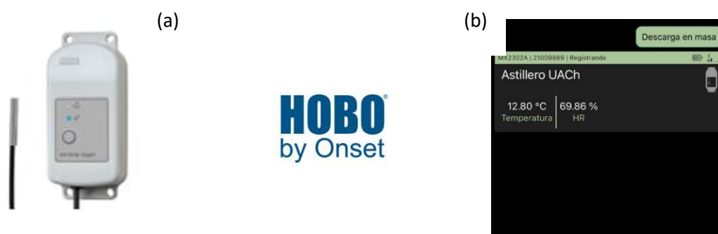
Figura 7-2: Sensor HOBO para medir la humedad relativa y temperatura (a) y aplicación para control de datos (b)
