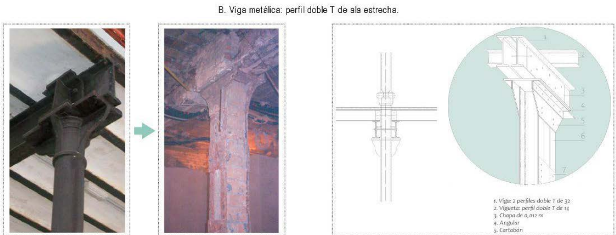
Figura 7: Comparativa del detalle B con referencia a la Azucarera Nuestra Señora del Pilar (Fotografía Beatriz Castilla). Caso de carrera metálica sobre soporte también metálico. Fuente: elaboración propia.
