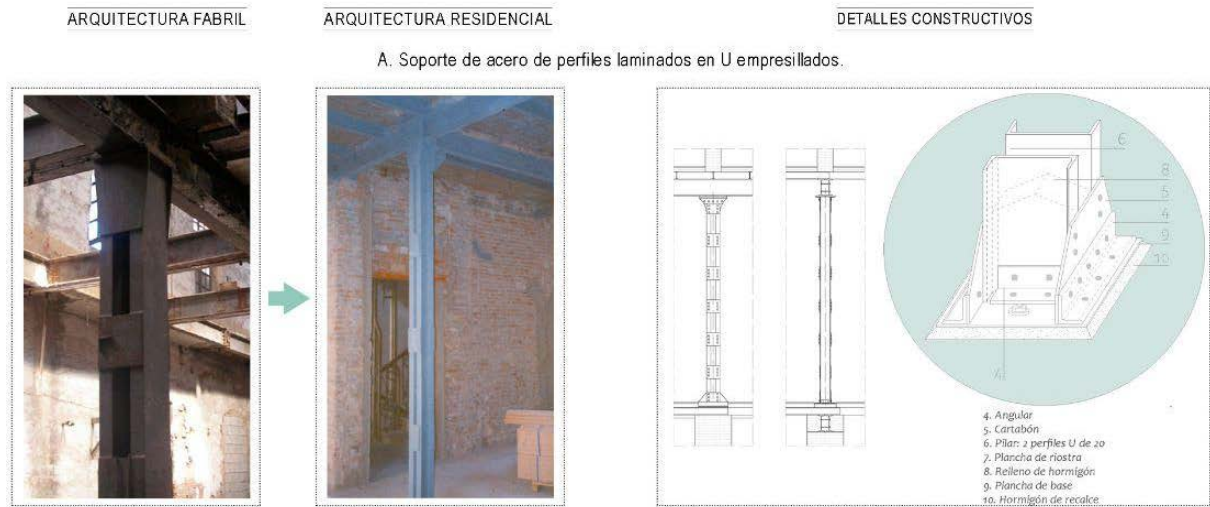
Figura 5: Comparativa del soporte correspondiente del detalle A con referencia a la ampliación de la Azucarera de San Isidro. Caso de pilar conformado por perfiles de acero laminado empesillado. Fuente: elaboración propia.
