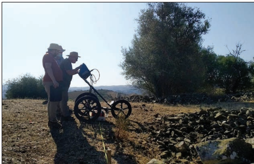
FIGS. 6 E 7 – À direita, trabalhos de prospeção geofísica com GPR ( Ground Penetrating Radar ) na zona da Cerca das Alcarias, a cargo do Laboratório de Geofísica e Sismologia da Universidade de Évora.
