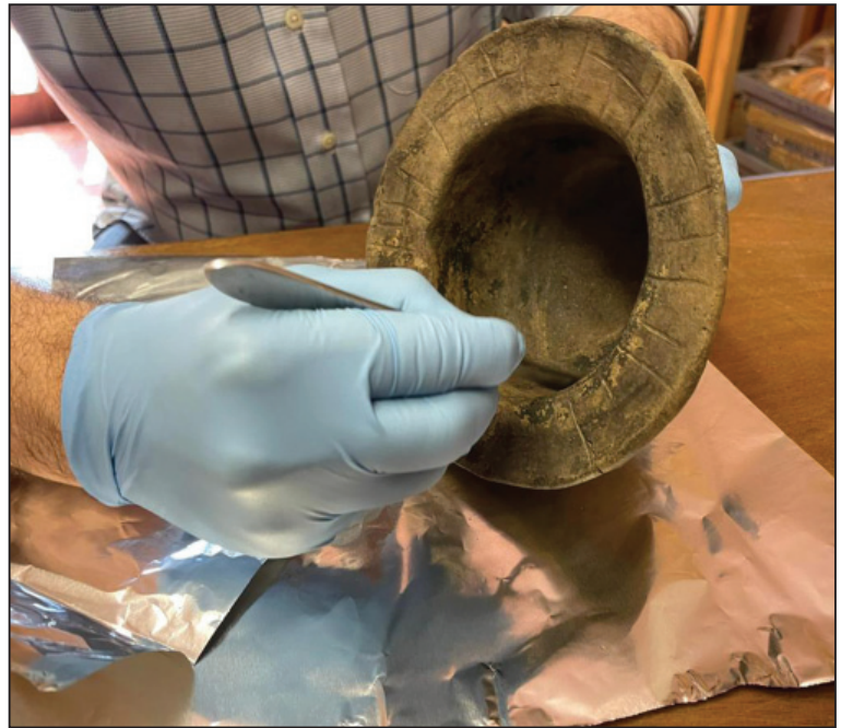
FIG. 7 – Pormenor do procedimento de raspagem do vaso e da recolha de material para análise cromatográfica.
