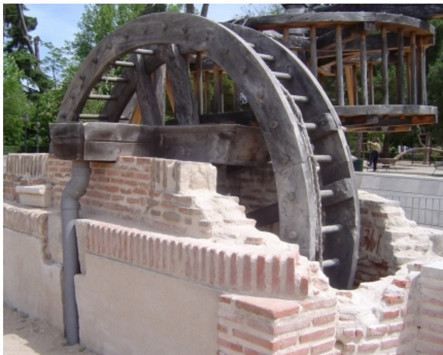
Fig. 14. Reconstrucción de una noria hidráulica, partiendo de diversos restos conocidos.
