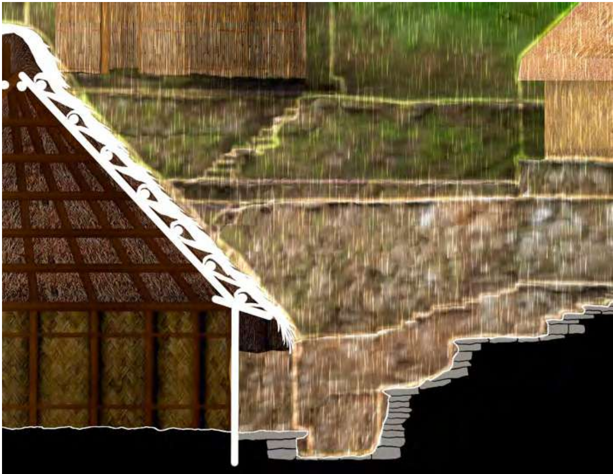
Figura 175. Funcionamiento de las lajas de goteo en relación con la conducción del agua lluvia.
