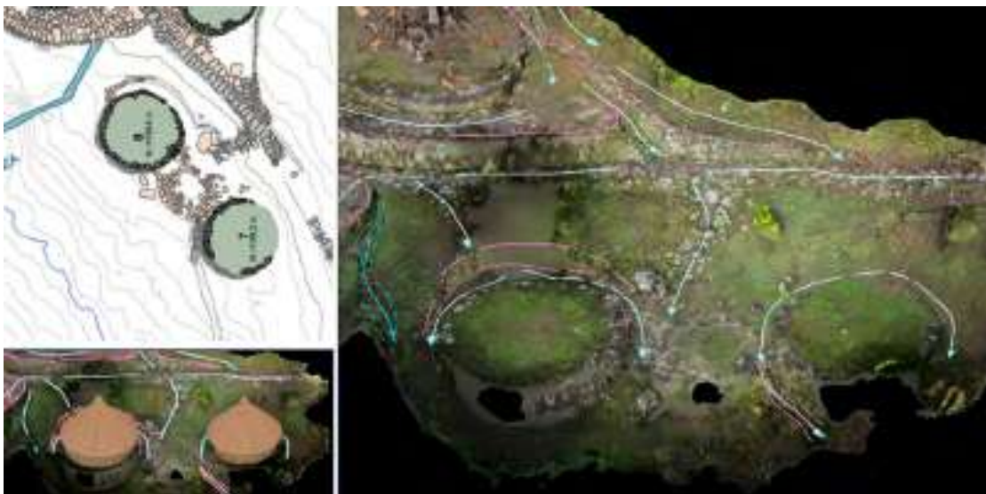
Figura 111. Drenaje de la terraza que contiene los anillos 7 y 8. Elaboración propia, 2023.
