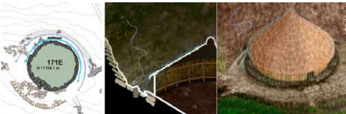
Figura 177. Identificación del canal posterior de un bohío para drenar el agua. Elaboración propia, 2023.
