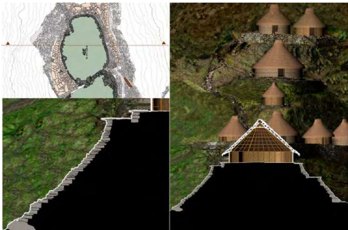
Figura 173. Sistemas de muros en piedra para formar plataformas con rellenos en tierra en Teyuna. Elaboración propia, 2023
