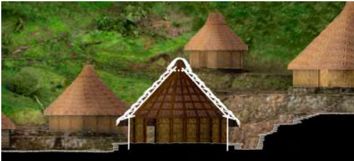
Figura 176. Construcción del bohío sobre anillo elevado que permite distanciar al bohío de la conducción del agua. Elaboración propia, 2023.
