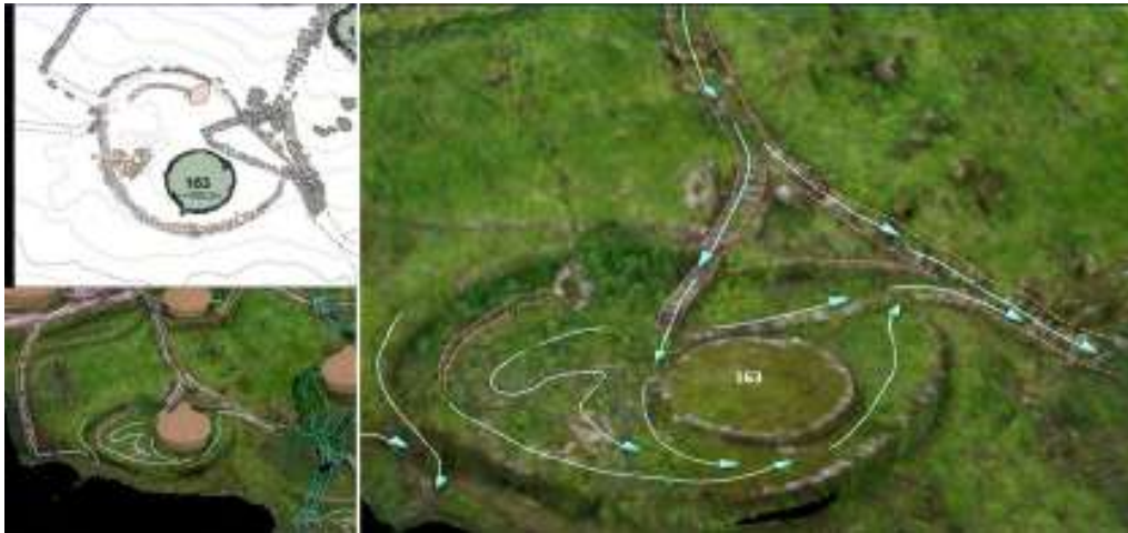
Figura 163. Movimiento del agua en las terrazas que contienen el anillo 163 y su entorno. Elaboración propia, 2023.
