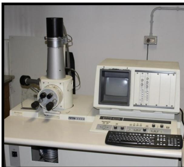
*Fig. 9 Microscopio Electrónico de Barrido S-510, Hitachi.*
