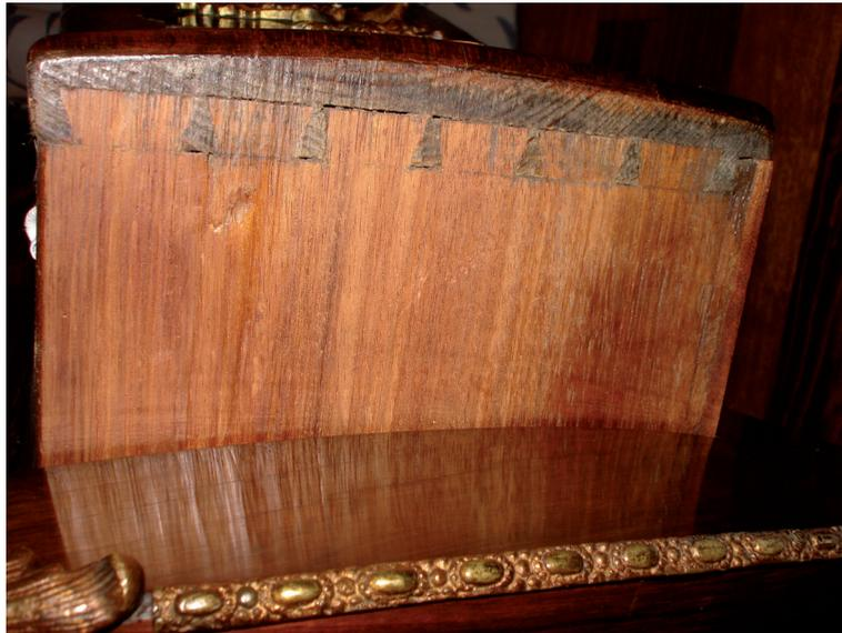
Figuras 17 y 17 a. Sistema de construcción del cajón de una cómoda portuguesa del siglo XVIII. El conocimiento de los sistemas de construcción de determinados ámbitos geográficos es una herramienta fundamental para delimitar ámbitos de producción. En el caso de la fotografía, una silla es inglesa, porque aparte de estar realizada en Inglaterra, se construye y ensambla de una manera concreta, que la diferencia de una francesa coetánea. Fuente: autor.
