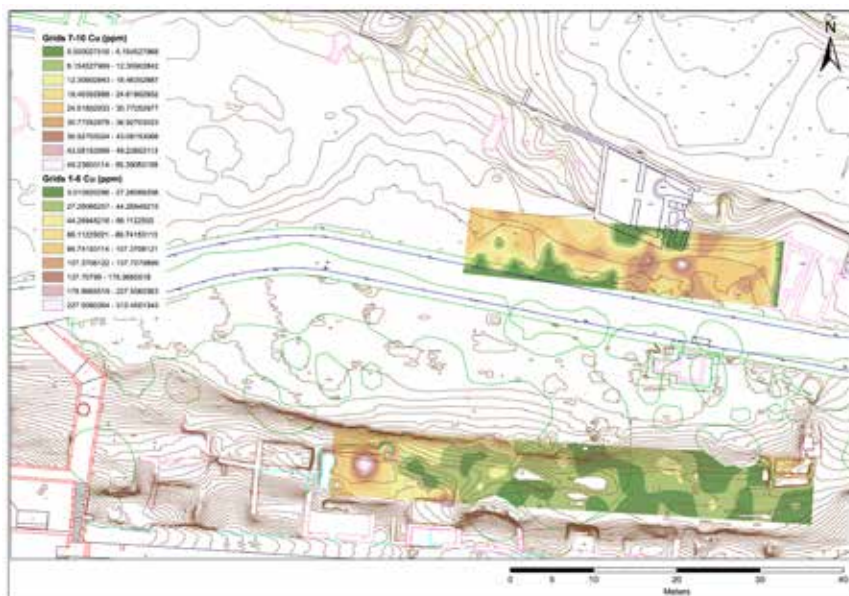
Figura 6. Georradar. Cuadrículas H-K. Antena de 500 MHz. Profundidad c. 2,5-3,2 m. Rojo = alta resistencia; azul = baja resistencia (K. Welham, D. Pitman sobre planimetría Patronato Alhambra Generalife)
