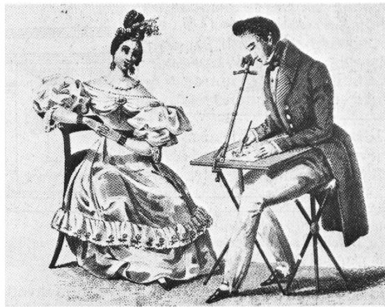
Cámara lúcida de Wollaston, ideada en 1806
