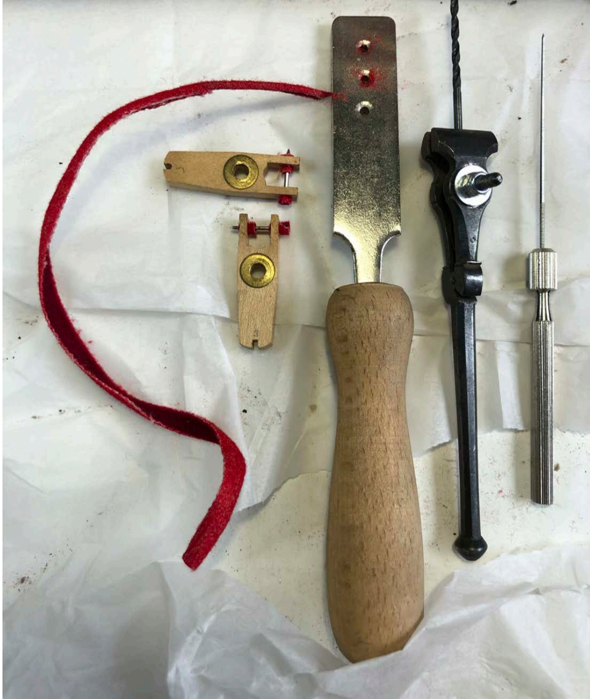
Figura 3. Proceso de restauración del piano Collard & Collard (Londres, ca. 1839), guarnecido de horquillas y ejes nuevos. Fuente: elaboración propia.
