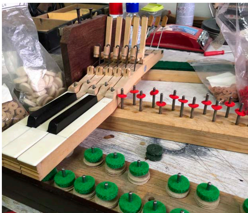
Figura 2. Proceso de restauración del piano Collard & Collard (Londres, ca. 1839), montaje del teclado. Fuente: elaboración propia.
