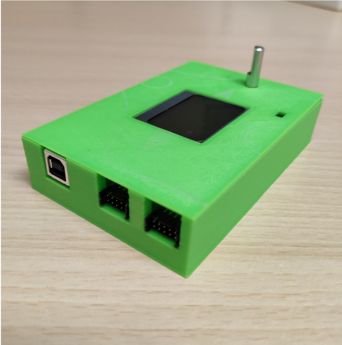
**Figure 5.9** – *Dispositivo medidor de campos magnéticos, resultado final.*
