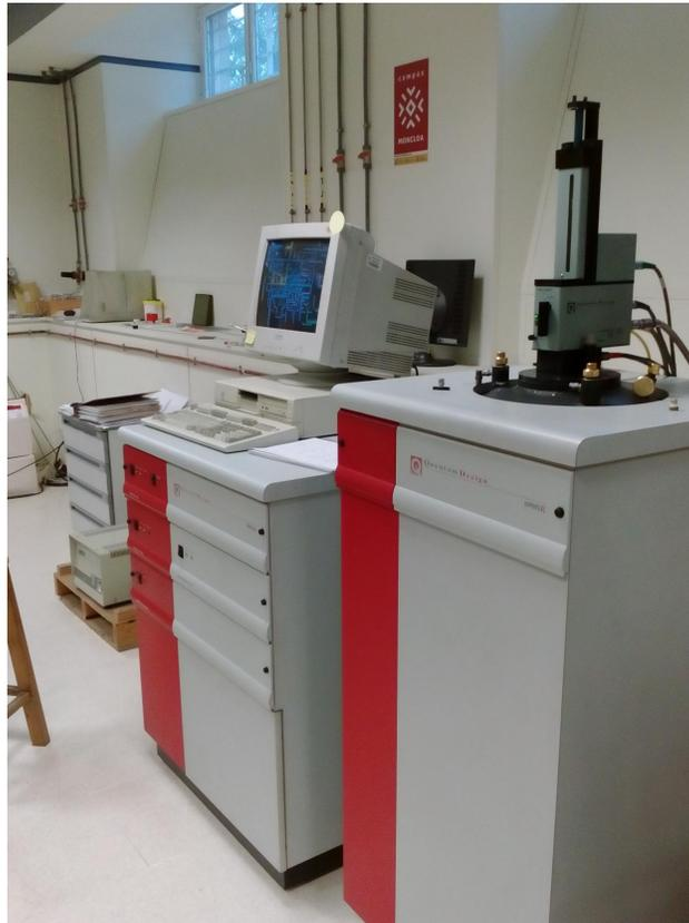
**Figure 3.12** – Magnetómetro MPMS-XL tipo SQUID, de la Universidad Complutense de Madrid [13].
