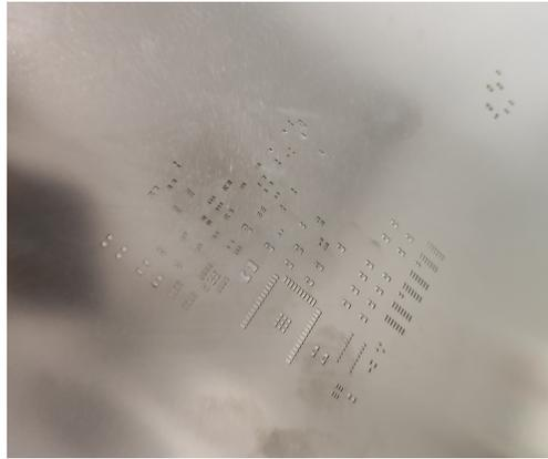
**Figure 5.3** – PCB ya encuadrada con el stencil.
