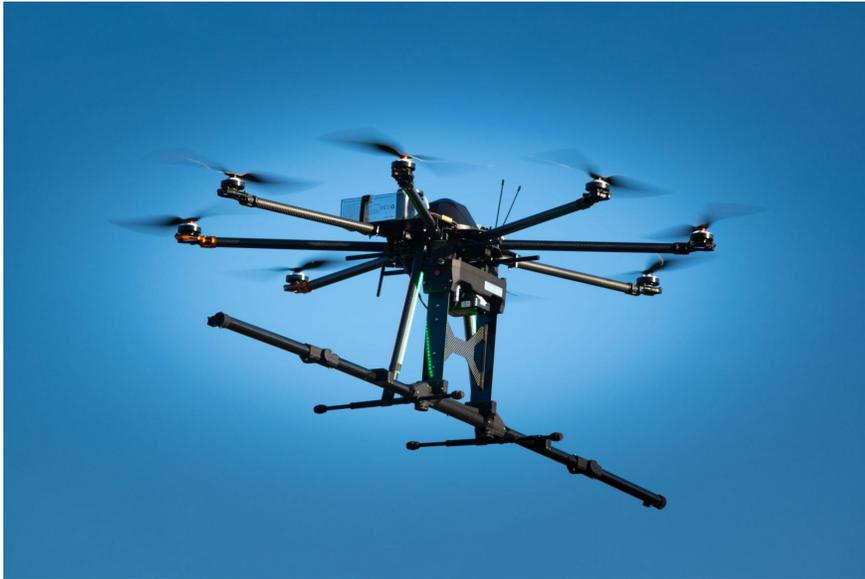
**Figure 3.2** – *Dron con magnetómetro incorporado para estudios geofísicos[7].*
