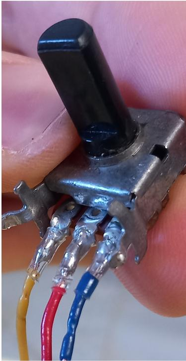
(a) Potenciómetro del Laboratorio con cables soldados con estaño y protecciones de plástico.
