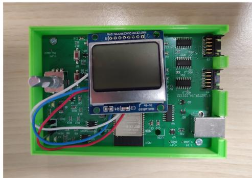
**Figure 5.8** – *PCB anclada a la base de la carcasa.*
