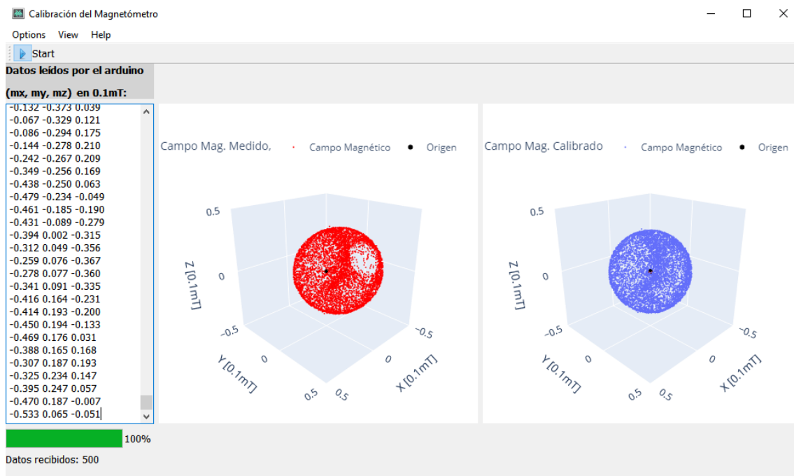
Figura 10: Ventana principal de la interfaz gráfica de usuario creada para la calibración del campo magnético terrestres medido con el arduino.
