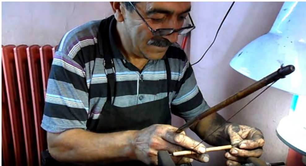
Fig. 90.- Artesano turco mostrando como se utilizaba el taladro de arco para la talla y perforación de piezas, en la forma de trabajo tradicional. Imagen: cortesía de E.H. Kinaci.
