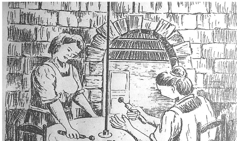
Fig. 121.- Ilustración representando a mujeres tallando en una piedra de grano (muela) movida por energía hidráulica en el Valle del Hers (Francia). Cortesía de Arlette Homs.
