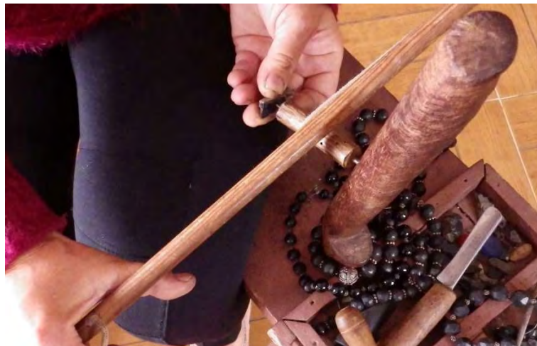
Fig. 95.- Detalle del uso del taladro de arco en la talla tradicional asturiana. Artesana Begoña Gutiérrez Fombella. Imagen: AMM.
