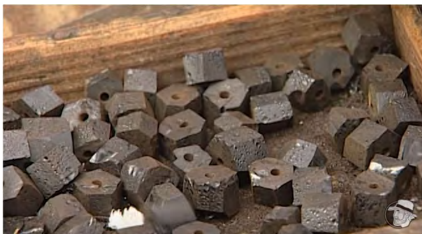
Fig. 109.- Cuentas preparadas para la realización de bolas facetadas de rosario contemporáneas ejecutadas mediante el sistema de trabajo tradicional asturiano, por el ya desaparecido Avelino Solares. Documental de Eugenio Monesma realizado a finales del siglo XX (Monesma, 1999).
