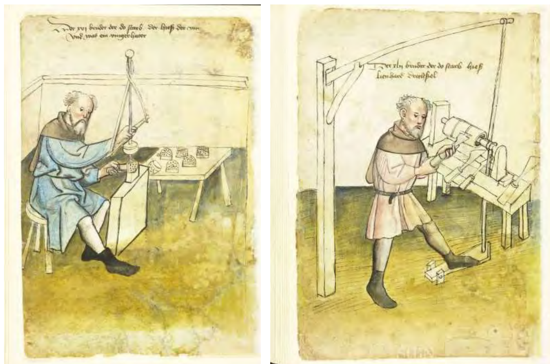
Fig. 101.- A la izquierda monje usando parahuso para perforar. A la derecha tornero usando un torno movido por pedal. Siglo XV. Imágenes propiedad y cortesía de la Biblioteca de Nuremberg.
