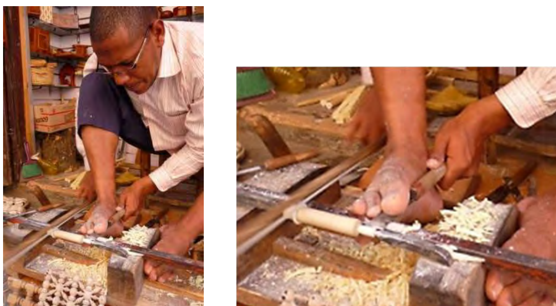
Fig. 97.- Artesano marroquí en la actualidad usando un torno con manos y pies para el trabajo de la madera. Imagen cortesía de Ney Tasbih.
