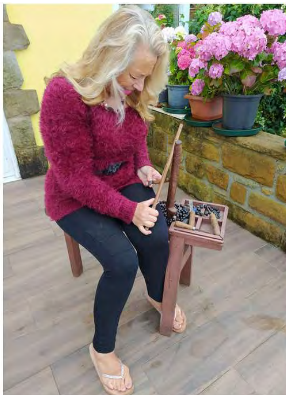
Fig. 122.- Begoña Gutiérrez Fombella, azabachera oriunda de Gijón y residente en Oles (Villaviciosa), usando el banco y taladro de arco de la talla tradicional de azabache en Asturias. Autor: AMM.
