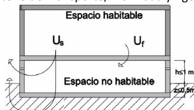
Figura 2. Esquema de suelo en contacto con cámaras sanitarias. Referencia: (Ministerio de Transporte, Movilidad y Agenda Urbana, 2020).
