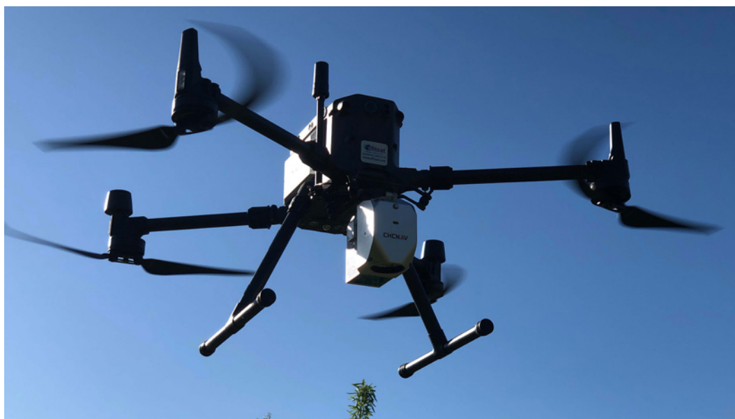
Figura 2. UAV DJI Matrice 300 RTK + CHC AA450
