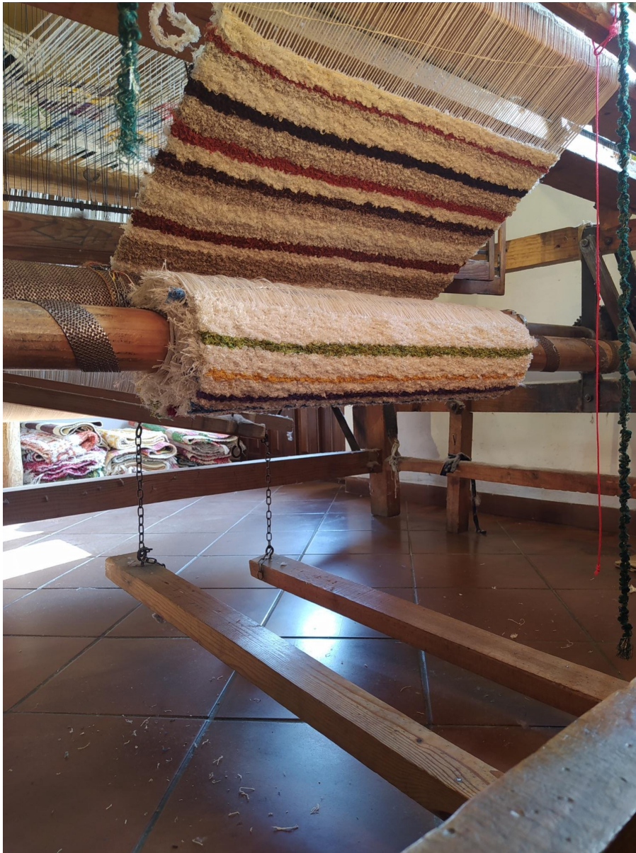
Doble pedal mediante el cual suben y bajan los lizos. Fotografía de la autora
