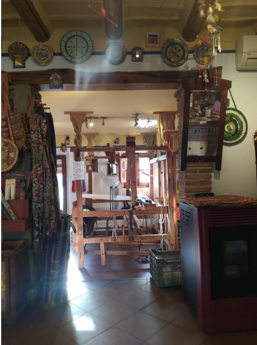
Telar de lizo con doble pedal. Fotografía de la autora.
