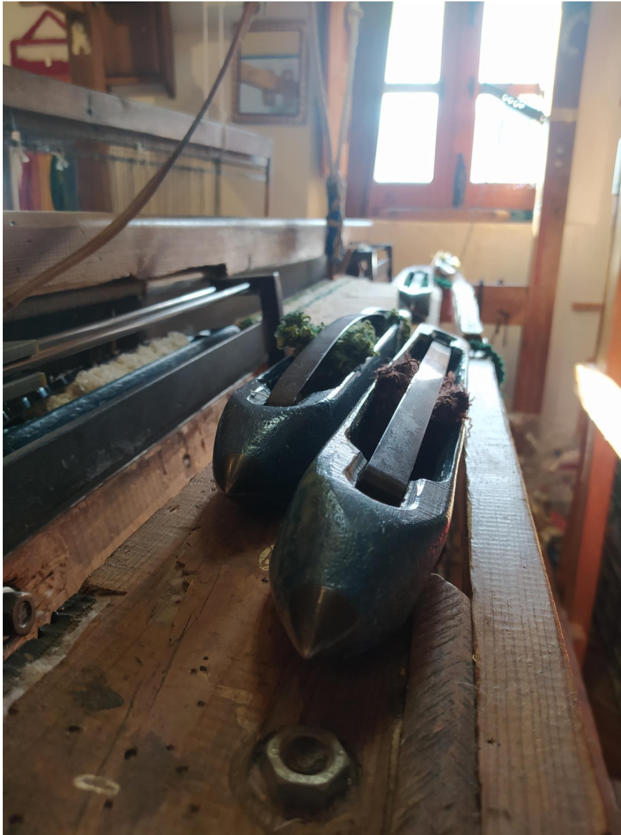
Lanzadera con los hilos de trama que se combinarán para formar la jarapa. Fotografía de la autora.
