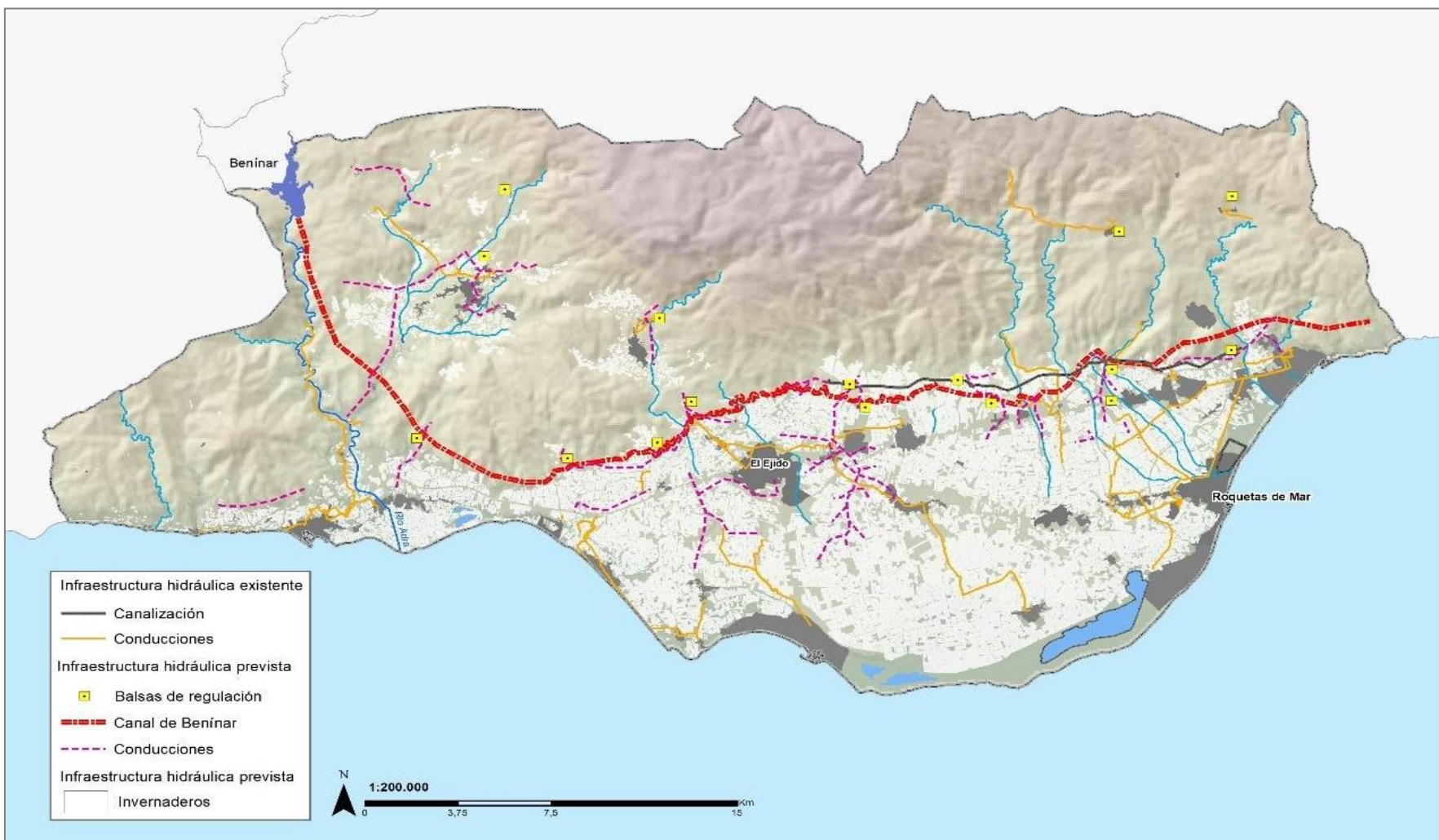
Figura 64. Estado de ejecución de las infraestructuras hidráulicas del Poniente almeriense. Fuente: PSOT y PHCAM. Elaboración propia.
