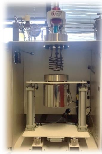
Figura 1.4. b. Parte interna del reactor Ilshin Autoclave
