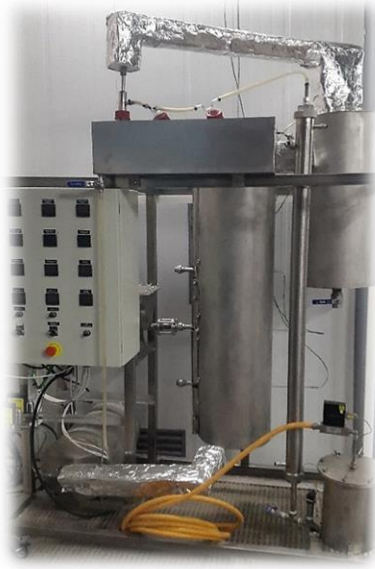
Figura 5.1. Planta piloto equipada con un reactor de lecho fluidizado utilizada para llevar a cabo ensayos de pirólisis y gasificación.
