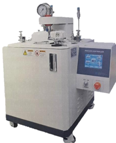
Figura 1.4. a. Parte exterior del reactor Ilshin Autoclave
