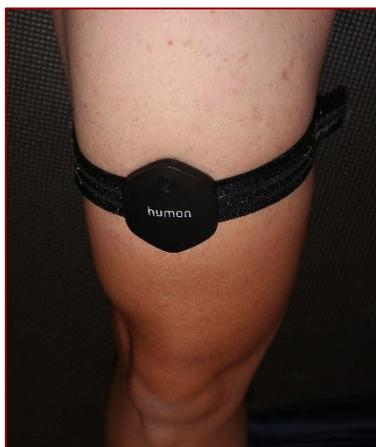
**Figura 10.** Colocación del dispositivo Humon Hex en el punto medio del recto femoral derecho.
