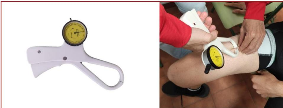
**Figura 1.** Plicómetro utilizado (izquierda) y toma del pliegue cutáneo en el punto medio del recto femoral (derecha).
