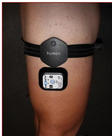
**Figura 2.** Colocación de los dos dispositivos NIRS en el recto femoral, Humon Hex en la parte proximal y Moxy en la distal.
