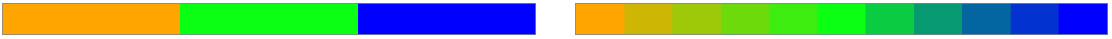
FIGURA 4.3 La parte izquierda de la figura muestra una paleta que no tiene activa la interpolación entre puntos de control. En la parte derecha, se muestra la paleta con la interpolación activada
