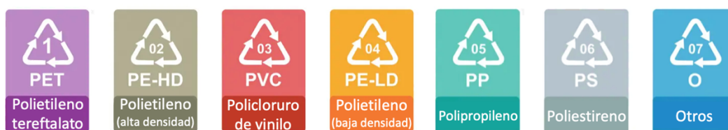
Fig. 3: Códigos de identificación de resinas de plástico. ISO 1043.
