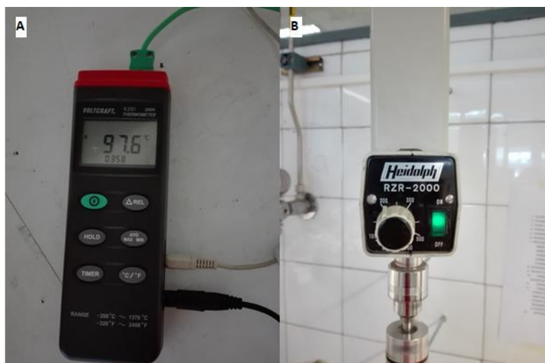
Figura 8. A) Termómetro utilizado para el control de la temperatura en el reactor, y B) Sistema de agitación acoplado.
