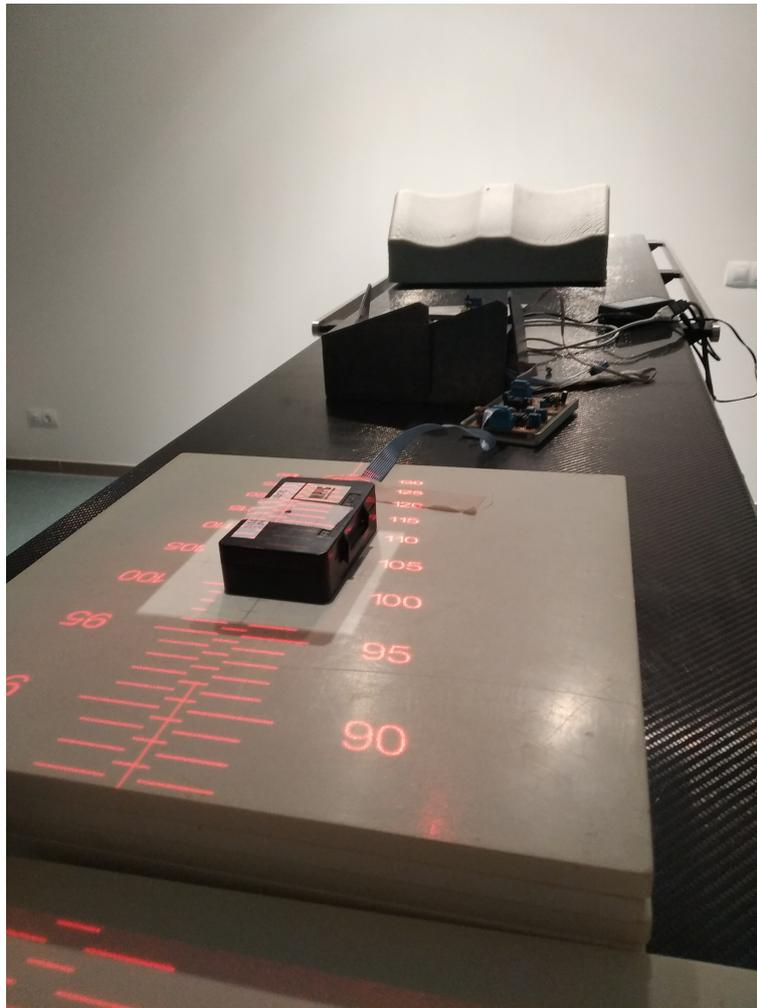
Figura 3.15: Montaje experimental de los fotodiodos y la unidad lectora. Las láminas de plomo se colocaron para proteger el sistema de lectura de la radiación.
