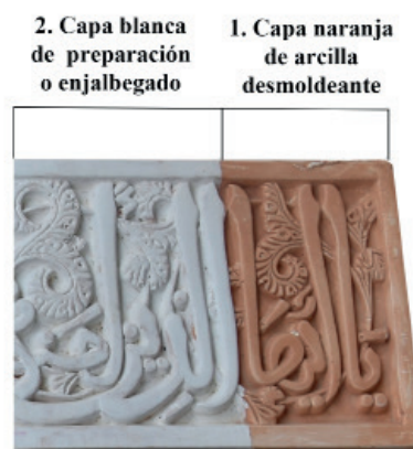
Figura 4. Detalle del modelo de yesería seleccionado. La técnica que reproduce es a molde, y es posible identificar las dos primeras capas: desmoldeante y preparación blanca.
