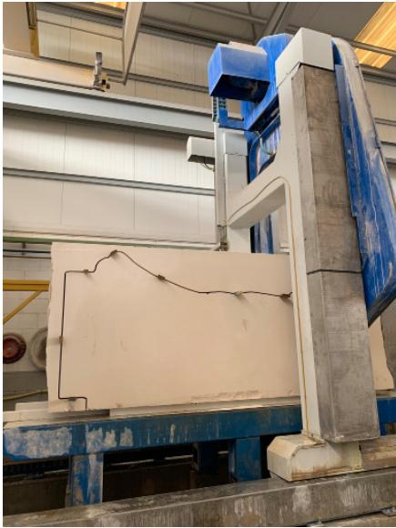
Figura 6. Eliminación de las zonas más grandes de la piedra en un centro de corte de hilo de Lozano Piedras Naturales.
