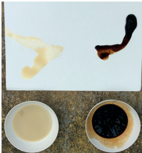
Figura 2. Disolución férrica (izquierda) e infusión gálica (derecha), con aplicación sobre papel de mesa docente.
