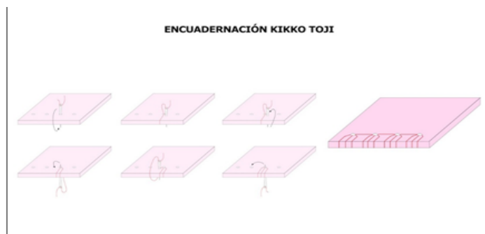
Figura 8 Esquema de las fases de cosido kikko toji
