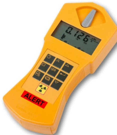
Figura 2: Contador Geiger portátil Gamma Scout empleado para tomar medidas.
