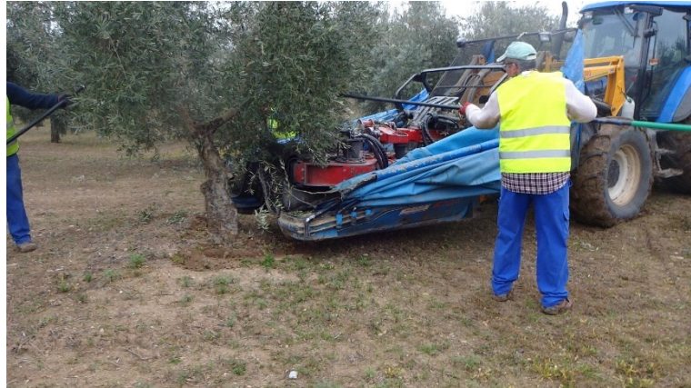
Figura 5. 5: Vibrador de troncos con paraguas y vareadores a mano. Medición en finca en Huétor Tajar. Fuente: elaboración propia
