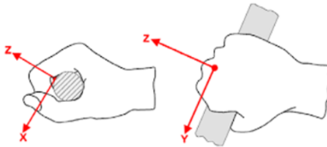
Figura 3. 6: Dirección de ejes definida en relación con la mano del cuerpo (sistema de referencia de la mano).
