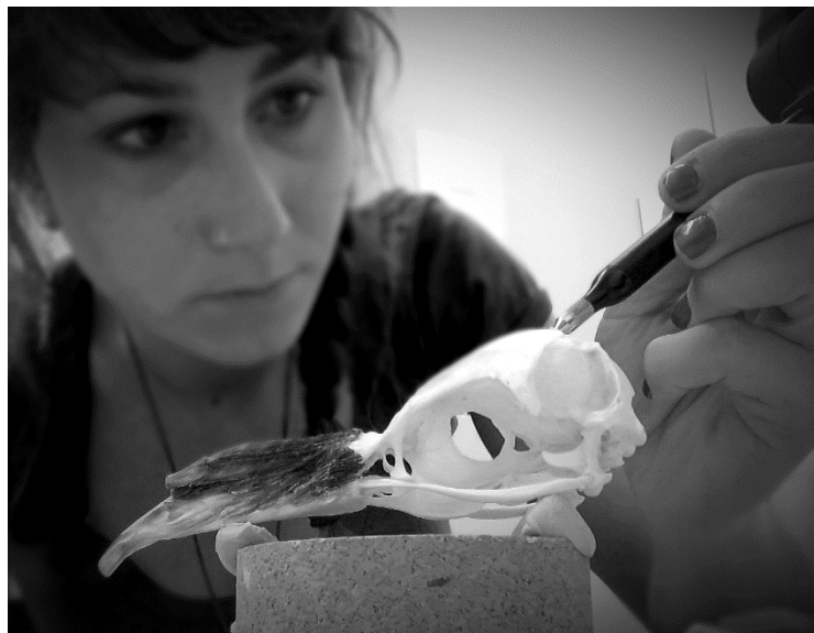
Figura III-22. Toma de landmarks con un MicroScribe o escáner de contacto, donde se registra la posición de cada landmark con un puntero directamente sobre el objeto de estudio.
