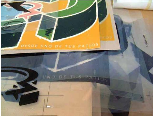
Fig. 265 . Fitolitos para impresión de una serigrafía a cinco tintas obtenidos con una impresora de gran formato Epson Stylus Pro 7000 sobre película AccuART2.
