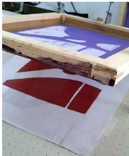
Fig. 273. Fijación provisional del papel junto con el fotolito, antes de colocar lo topes, durante el proceso de ajuste del registro.
