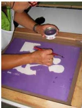
Fig. 268. Retoque de la pantalla con pincel y emulsión.
