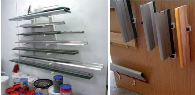
Fig. 226. Izq. Racletas y contrarracletas correctamente almacenadas, en un taller profesional; dcha. racletas de diferentes tipos usadas en un cursillo de verano. Advértase que los alumnos han hecho un uso incorrecto del sistema de colgado, excepto en el caso de la primera a la derecha, con lo que pueden resultar dañadas las tiras de material elástico.
