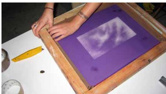
Fig. 269. Sellado interior de la pantalla con cinta adhesiva de embalaje.
