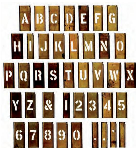
Fig. 3. Juego de plantillas metálicas para rotulación usadas por el ejército norteamericano durante la II Guerra Mundial. (1945). (Benson)
