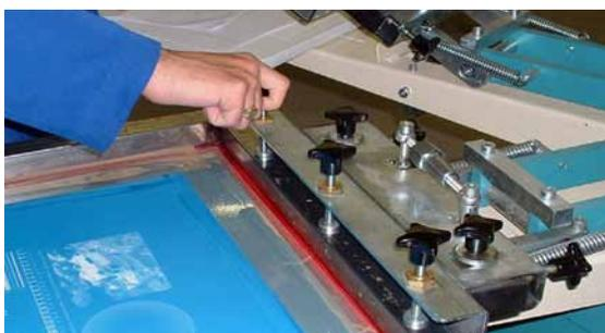
Fig. 270. Fijación de la pantalla al mecanismo de bisagra.
