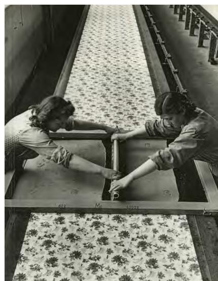
Fig. 235. Mesa para estampación textil. La tela se fija a la mesa y la pantalla se va desplazando longitudinalmente.
