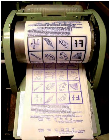
Fig. 57. Multicopista o Mimeógrafo con cliché montado y hoja impresa. (c. 1950)
