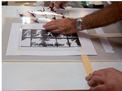
Fig. 272. Ajuste manual del registro mediante tiras de cartulina que permiten desplazar la hoja de papel con el fotolito bajo la pantalla hasta que ambos coincidan.
