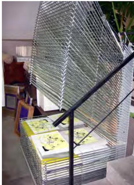
Fig. 277. Secado de las hojas impresas en el *Rack* de secado.
