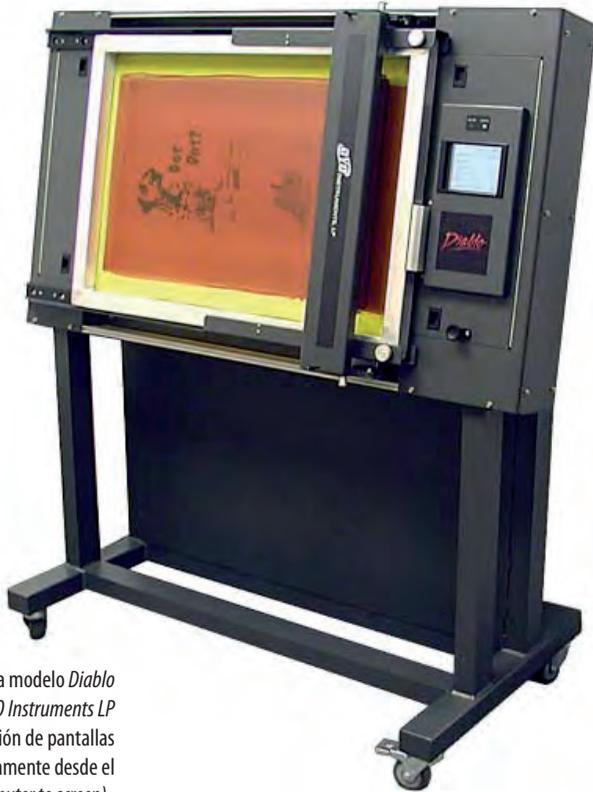
Fig. 83. Máquina modelo *Diablo* fabricada por *OYO Instruments LP* para la confección de pantallas serigráficas directamente desde el ordenador (*computer to screen*).
