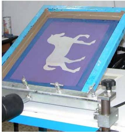
Fig. 200. Pantalla preparada para imprimir. En violeta las zonas no impresoras, donde la malla está obturada, y en blanco las zonas impresoras, donde la malla está abierta y por tanto es permeable a la tinta.
