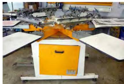
Fig. 234. Mesa de impresión textil ("pulpo" o "carrusel")
