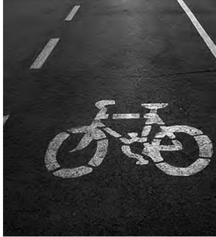
Fig. 37 Señal de carril bici realizada mediante la técnica del estarcido sobre el asfalto de una calle.
