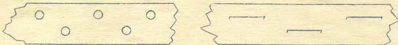
Se procede luego al clavado del lado contiguo, de la misma forma. En seguida se tensa en diagonal clavando un clavito o chincheta en el ángulo opuesto al ya clavado y se termina como queda indicado en el dibujo.
