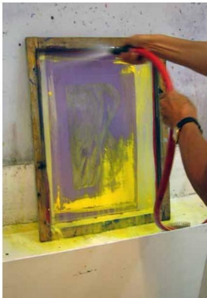
Fig. 280. Eliminación de los restos de la tinta de base acuosa con agua a presión.
