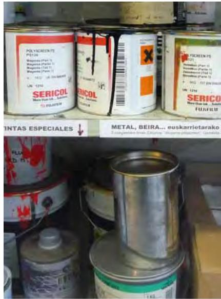
nica. Inicialmente secan por evaporación en un periodo de tiempo corto, si bien su secado total no se producirá hasta finalizar el proceso de catalización el cual puede durar varios días. Este proceso puede ser acelerado si se somete a la acción de radiación infrarroja. Tras el secado completo se forma una película muy sólida y estable. Se pueden emplear sobre soportes de cerámica, cristal, metales, plásticos, etc.
