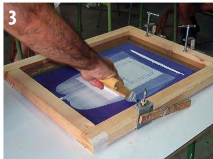
haga contacto con el soporte a imprimir, se pasa la racleta hacia la parte de atrás dejando una capa de tinta uniforme recubriendo toda la pantalla.
