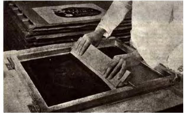
En su versión más básica una mesa de impresión consta de un tablero con unas bisagras que se encargan de sujetar la pantalla permitiendo que ésta suba y baje. La pantalla se coloca bajada para imprimir y subida para reentintar y sustituir la hoja.
