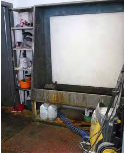
Fig. 283. Pila de revelado y limpieza con respaldo iluminado.
