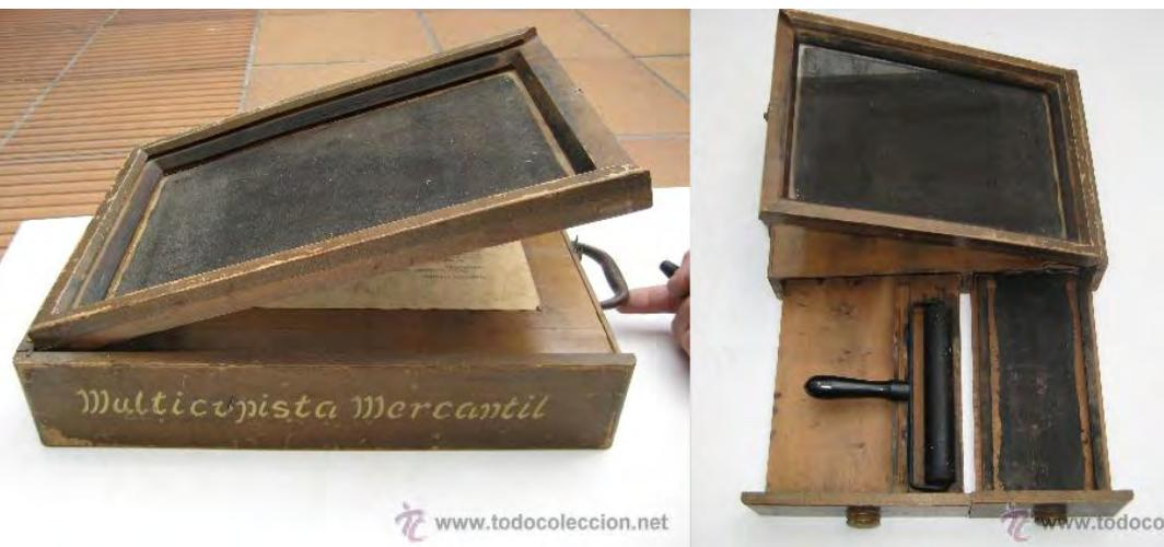
Fig. 39. *Multicopista Mercantil*, versión hispana del Mimeógrafo de Edison. (c. 1930). Se puede distinguir perfectamente la pantalla de madera y seda en la que se sostenía el cliché, así como el rodillo de entintar. (todocoleccion.net)
