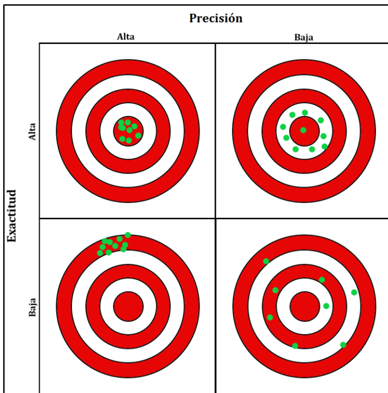
Figura 6.8. Representación de los grados de exactitud y precisión
