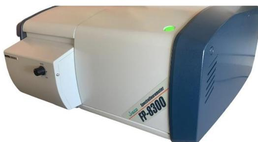
Fig. III.2. Fotografía del espectrofluorímetro de estado estacionario JASCO FP-8300.
