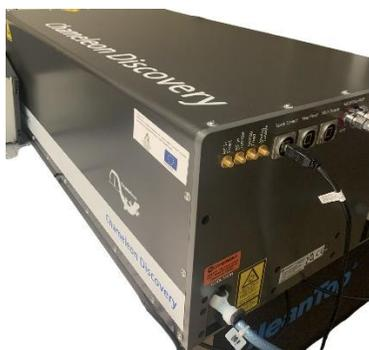
Figura III.7. Sistema Discovery Laser. Fotografía del cabezal láser (no se muestra la MRU, la fuente de alimentación ni el refrigerador).
