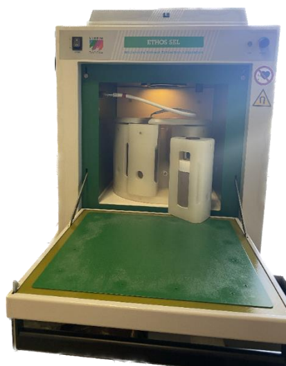
Figura 18. Horno de microondas de laboratorio. Fotografía propia
