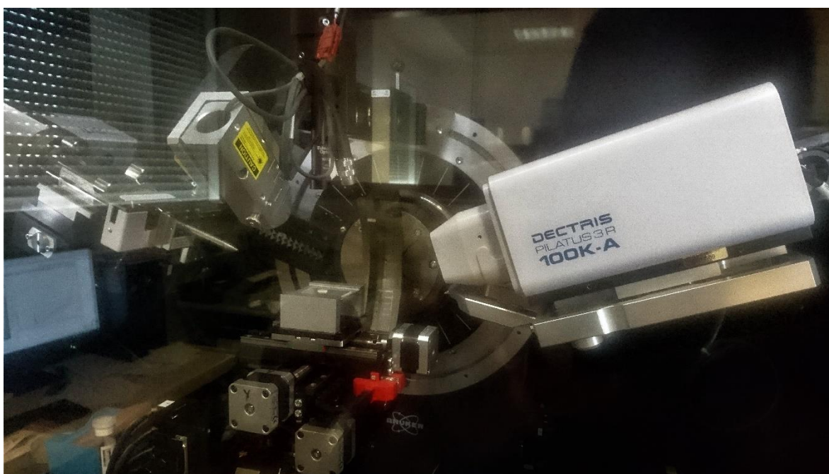
Figura 23. Difractómetro de Rayos X Bruker D8 DISCOVER con detector 2D (DECTRIS PILATUS 3R 100K-A).
