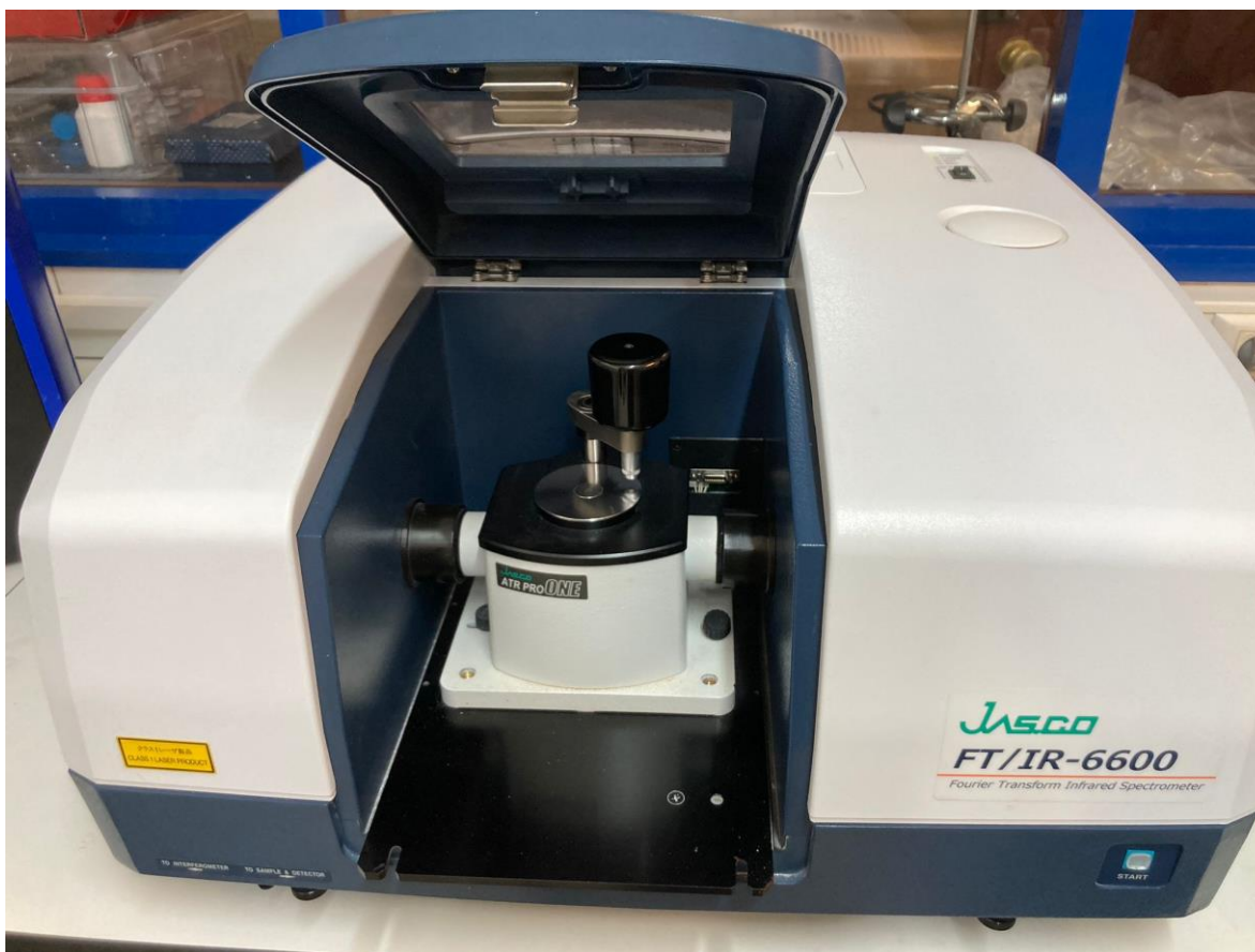
Figura 21. Espectrómetro FTIR Jasco 6600 con accesorio ATR empleado para el análisis de las muestras.
