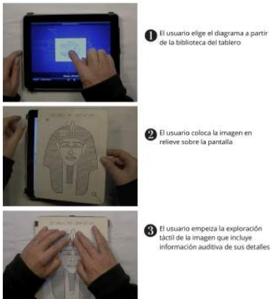
Figura 5.17. Funcionamiento del Tact2Voice
