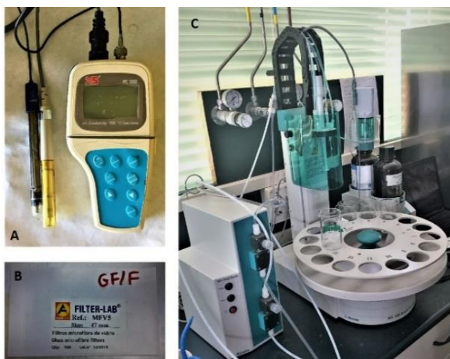
Figura 12. Instrumentos usados para la medición de parámetros físicos y químicos del agua de los ecosistemas muestreados. A: Sonda paramétrica, B: Filtros de fibra de vidrio, C: Titriador para medir la alcalinidad.
